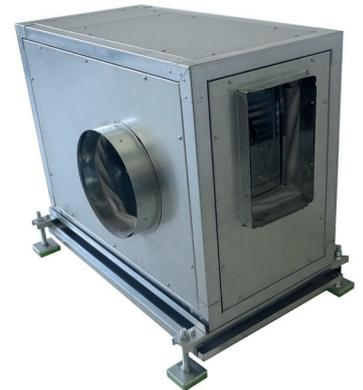
Caja de ventilación construidas con ventiladores de simple aspiración y accionadas mediante transmisión, homologadas en el laboratorio Centre Technique de la construction Metallique (C.T.I.C.M.) de Mezt-Francia, según Norma Europea pr EN12101.3, para transportar aire a 400°C 2/h y especialmente diseñadas para trabajar en el exterior de las zonas de riesgo.
