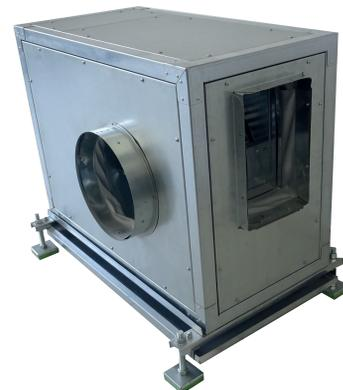
Caja de ventilación construidas con ventiladores de simple aspiración y accionadas mediante transmisión, homologadas en el laboratorio Centre Technique de la construction Metallique (C.T.I.C.M.) de Mezt-Francia, según Norma Europea pr EN12101.3, para transportar aire a 400°C 2/h y especialmente diseñadas para trabajar en el exterior de las zonas de riesgo.
